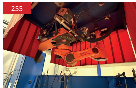
Schweißroboter Fabrikat: CLOOS, Typ: QRC 360 2W Bj. 2021 Ø 1200/200 mm
