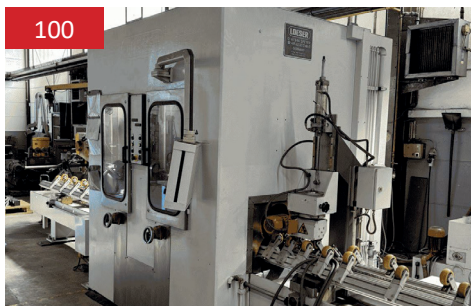
2-Stationen- Rundschleifmaschine Fabrikat: LOESER, Bj. 2019 Ø 80 - 250 x 3.000
