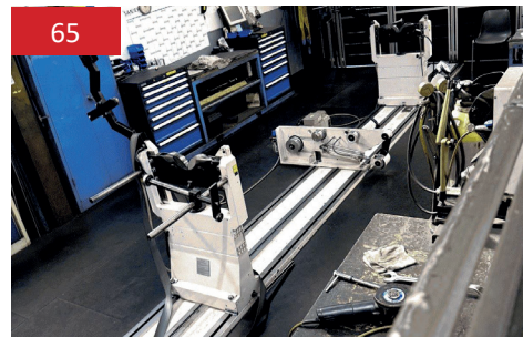
Auswuchtmaschine Fabrikat: CEMB HOFFMANN, Bj. 2020 Ø 1200 mm x 8000 mm
